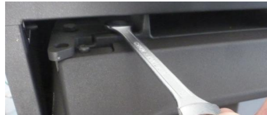
Figura n°9 - Aflojando el soporte de la puerta con llave fija de 10
