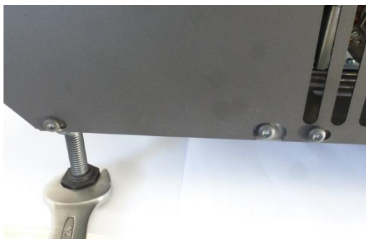
Figura nº4 - Detalle de llave fija de 24 para regular las patas
