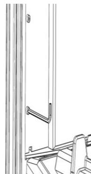
*Figura n°10 - Serrare le viti con una chiave a brugola senza stringerle fino in fondo.*
