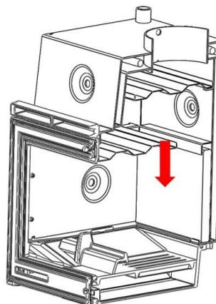
*Figura n°9 - Inserire il pezzo girando e spingendo verso l'alto, fino a far scattare la linguetta inferiore, quindi lasciare cadere*
