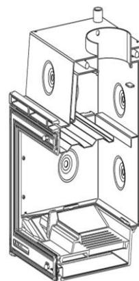
Figura n°19 - Vista in sezione con deflettore collocato (Sarria-Sakan)
