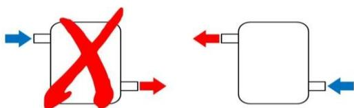
*Figura n°15 - Collegamento scorretto (sin.) e collegamento corretto (dest.)*
