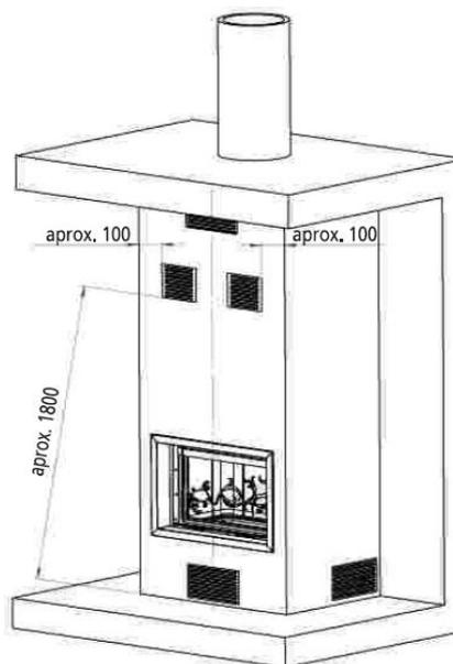
Figura n°8 - Schema esterno del rivestimento
