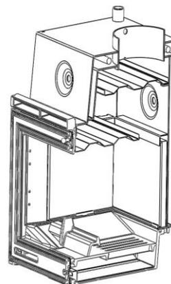
*Figura n°22 - Vista in sezione con due deflettori collocati (Sarria-Sakan Plus)*
