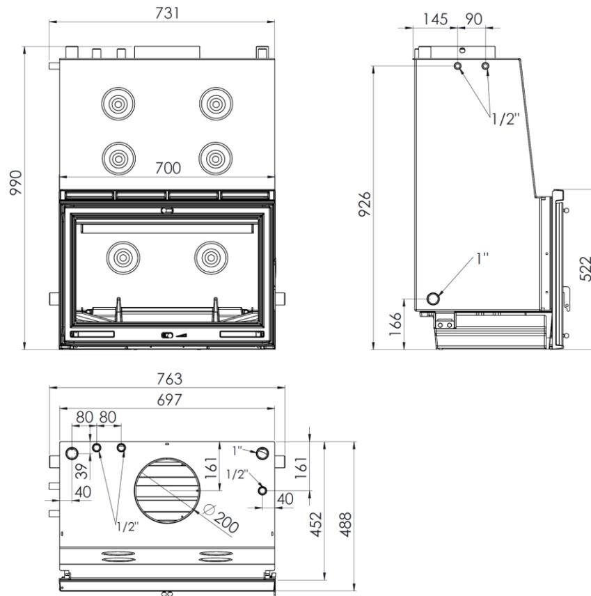
Figura n°5 - Dimensioni in mm dell'apparecchio SARRIA 16 - SAKAN 16
