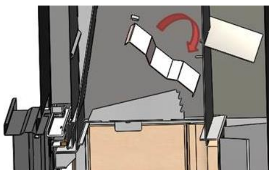
Figura nº20 - Desmontagem do defletor médio Inca
