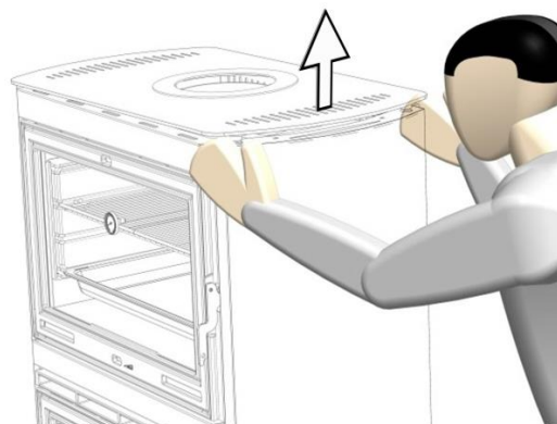
Figura nº19 - Movimento para elevar a placa
