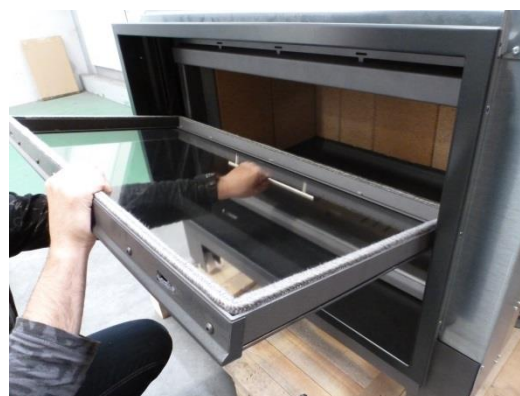
Figura nº33 - Puerta completamente abatida
